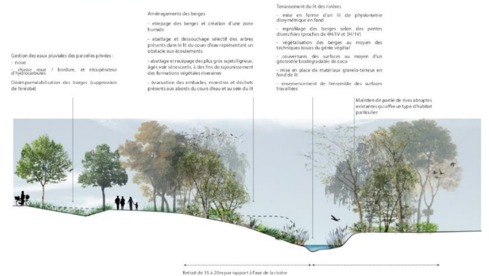
Principe de la renaturation des rivières - Coupe type dans le respect des préconisations de GREN, la loi sur l'eau, le contrat rivière
